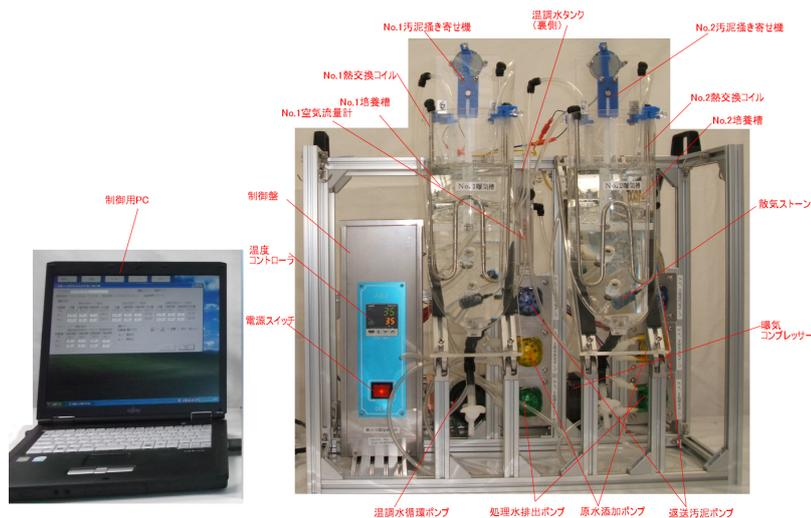
2 連培養テスト機で比較培養処理を行い、TSchecker で各汚泥の活性を測定することで、阻害性廃水の処理テストや、非常運転（定修時など）時の最適運転条件など、いろいろな情報を得ることができます。
